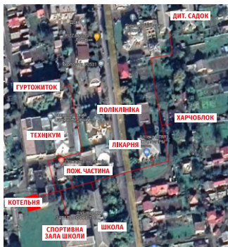
Зображення 3 – Схематичне зображення прокладання теплових мереж
